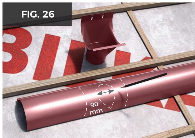
Cu ajutorul unui bomfaier sau cu o foarfecă manuală, se decupează după trasaj (FIG. 27, 28).
