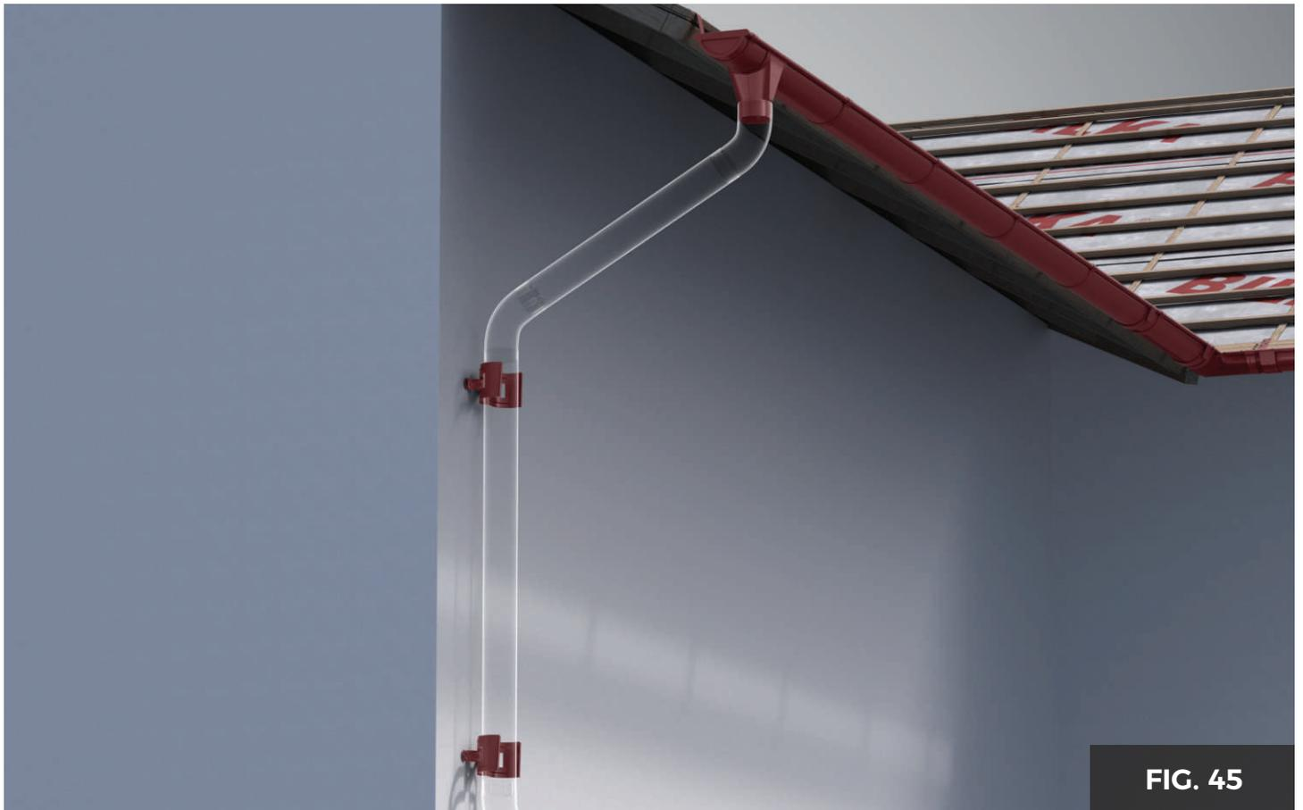
După ce burlanele au fost poziționate în coliere, se vor introduce penițele de siguranță în cele două ghidaje cu care fiecare colier este prevăzut din fabrică.
