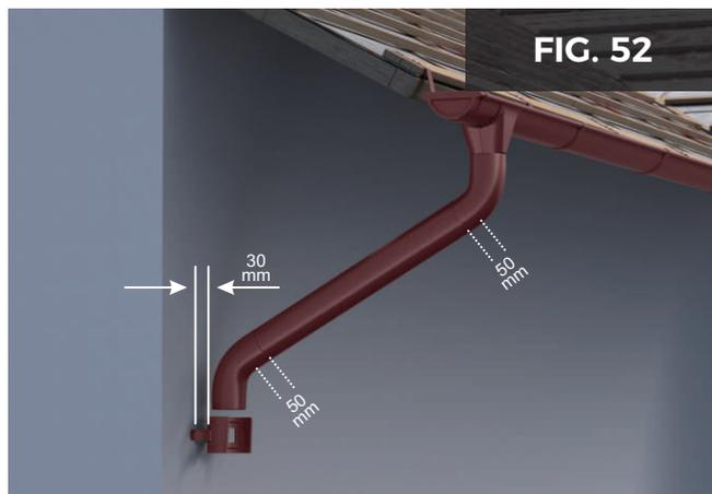
Odată ce coturile și prelungitorul au fost montate, urmează dimensionarea burlanului, care se realizează astfel:
